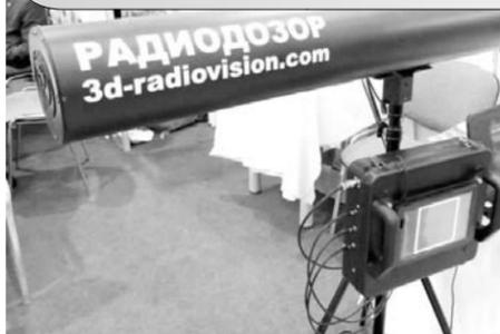
В буквальном смысле смотреть сквозь стены умеет стеновизор «Радиодозор», разработанный учеными РФФ ТГУ. Он определяет местоположение и траекторию движения людей, анализируя их перемещение и дыхание с использованием сверхширокополосного излучения. Установку можно применять при ликвидации угрозы терроризма, освобождении заложников, поиске людей под завалами и т. д. «Радио-
