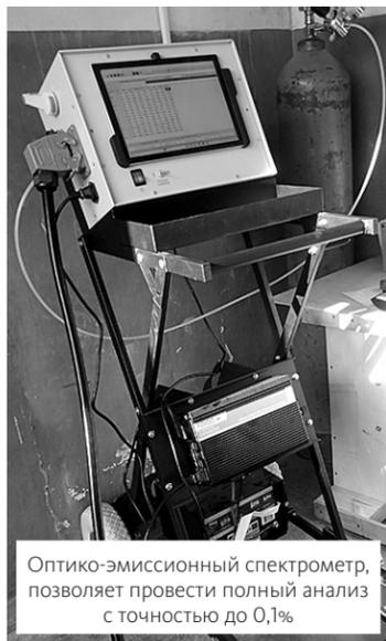
Оптико-эмиссионный спектрометр, позволяет провести полный анализ с точностью до 0,1%
