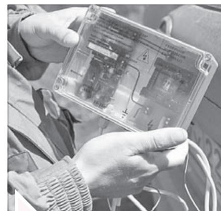
■ Генератор импульсов – самая важная часть системы «электропастух». Прибор подключается к обычному автомобильному аккумулятору и надежно защищает стадо
