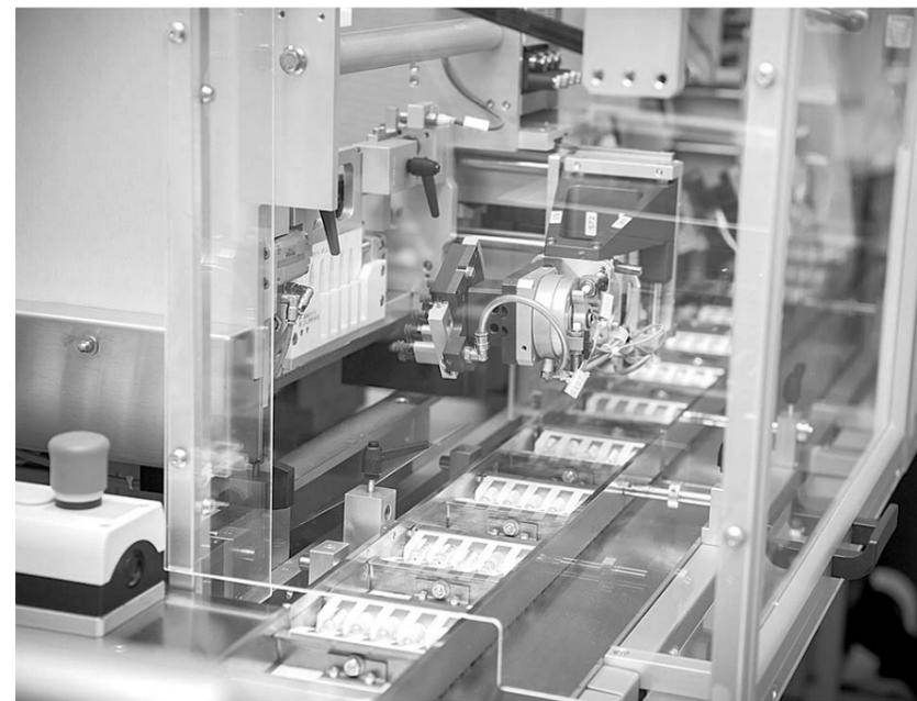
■ В этом помещении идет процесс разлива вакцины и запаивания ампул. Современное высокотехнологичное оборудование практически исключает вмешательство человека в производство
