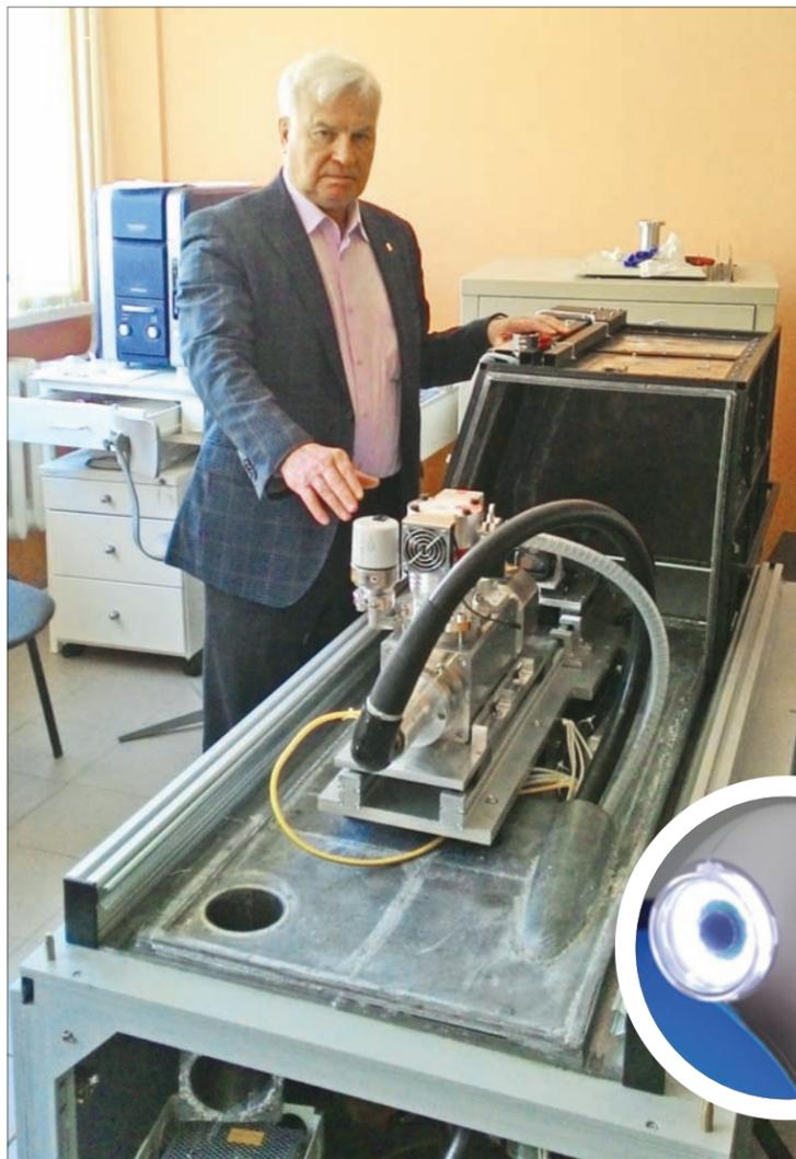
■ Владимир Сырямкин демонстрирует интеллектуальный рентгеновский 3D-микротомограф. Прибор используется для диагностики и оценки состояния конструкционных материалов и узлов бортовой радиоэлектронной аппаратуры
